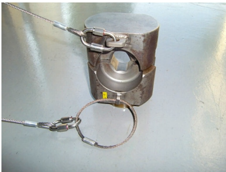
100 t 落下防止ワイヤー取付状況
