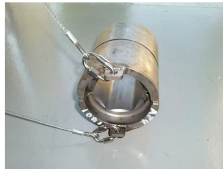
200 t 落下防止ワイヤー取付状況
